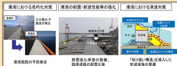
図：既設防波堤の粘り強い構造化等のイメージ (出典：国交省ウェブサイト)
