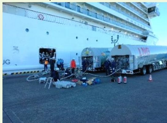
写真16：「飛鳥Ⅲ」のLNGバンカリング（再掲）
