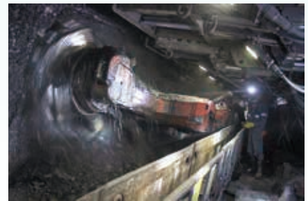
太平洋煤礦領先世界，首次將「SD採煤法」 (長壁式採煤)投入實際應用
