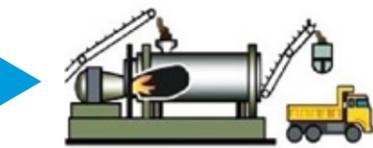
**乾燥機** ●汚泥を乾燥させて水分を飛ばす
