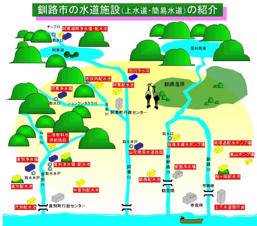
図 2.1 釧路市の浄水場と配水池
