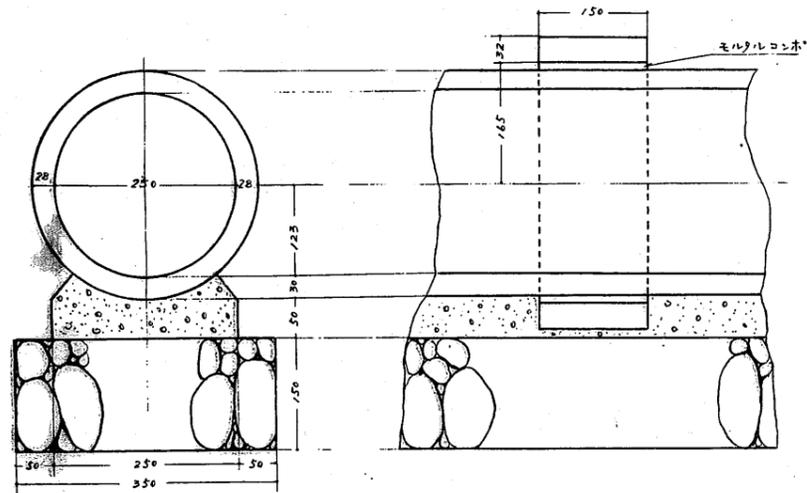
$\phi 700 \times 90^\circ$  曲管防護詳細  $s=1/20$
