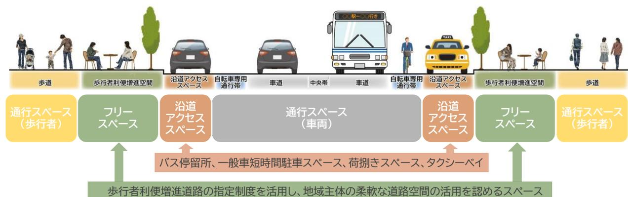
図.ウォークブル道路の横断面構成の基本的な考え方 (北大通 (道道区間) を事例として)
