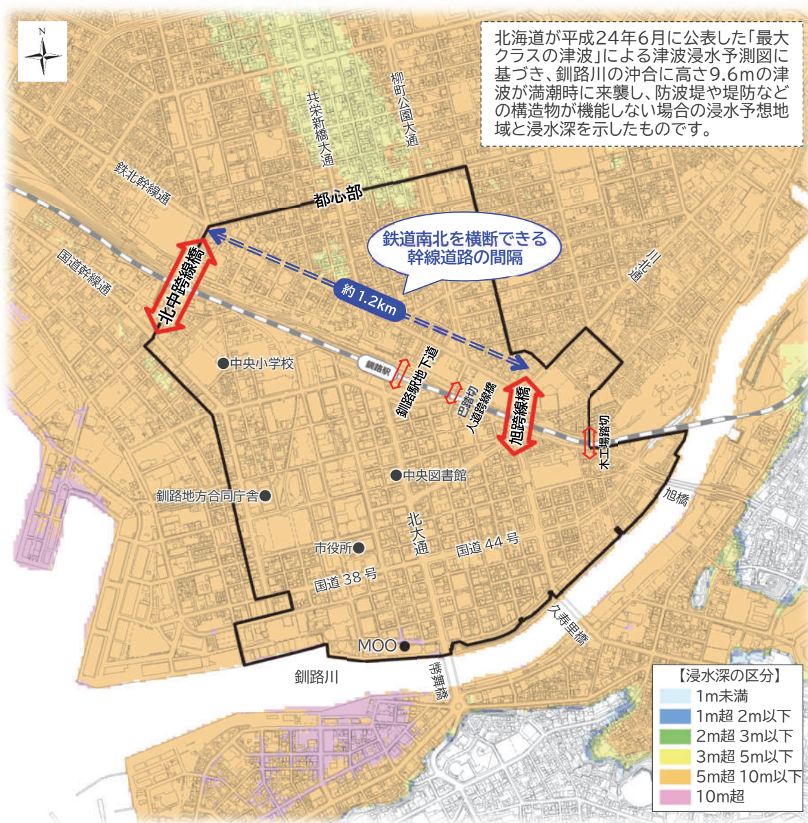
図表 都心部における津波浸水予測と鉄道南北の避難経路
