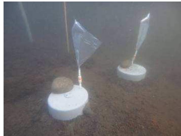
湖底湧水を採取するために 設置されたシーページメータ
