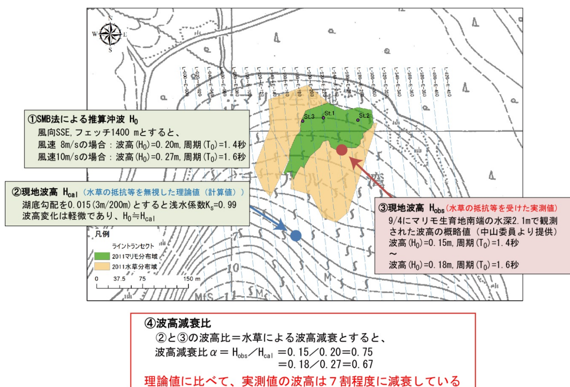
図 2-1-7 チュウルイ湾の水草繁茂による波浪減衰の検討結果
