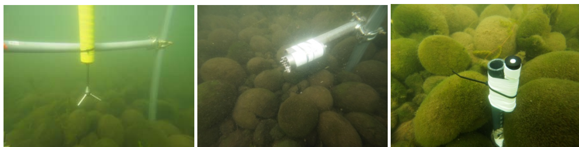
図 2-1-2 阿寒湖チュウリイ湾における観測機器の設置状況。左：流向流速計、中：クロロフィル・濁度計、右：光量子計
