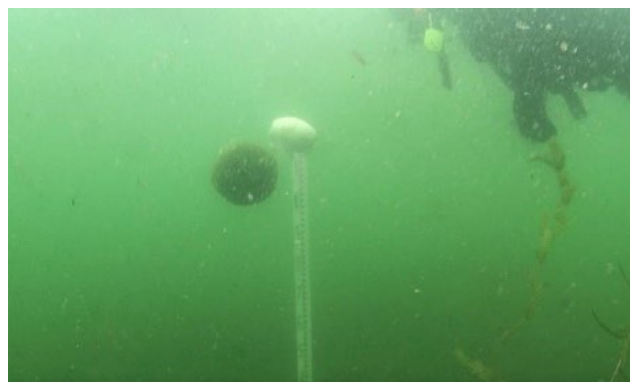
図 10 現場での沈降実験による比重の計測例
