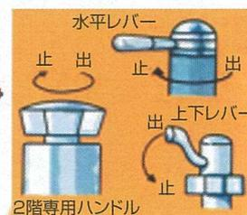
②水抜栓（元栓）のレバー、ハンドルを『止』の方向に動かす。
