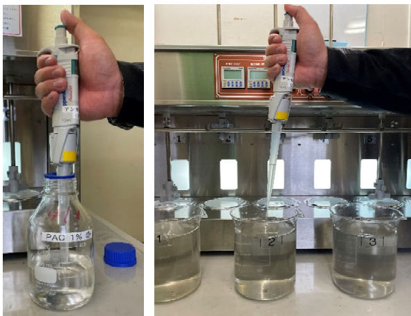
薬品注入の様子
