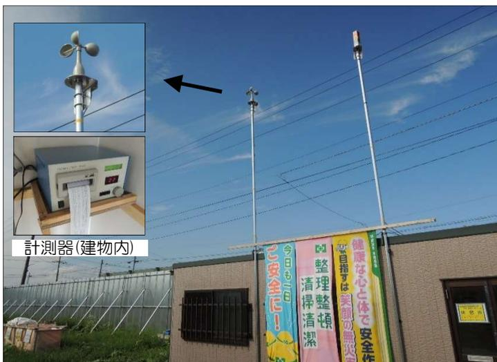
風速を常時計測しクレーン作業等の安全対策を施しています。
