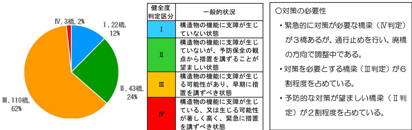
図 10 健全度評価結果 (H26～H28) ※橋梁点検結果を健全度評価した結果
