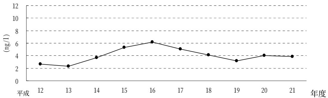
図3-2-15 境橋地点におけるBOD値経年変化
