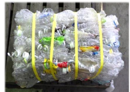
約500本のペットボトルを機械で圧縮し、「ボール」と呼ばれるかたまりを作ります。その後ボールはリサイクル工場に運ばれて、新たなペットボトルに再生されます。
