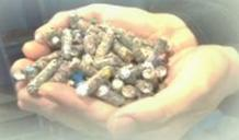
粉碎・圧縮・成型の処理を行って、最終的にペレット状の固形燃料を製造します。
