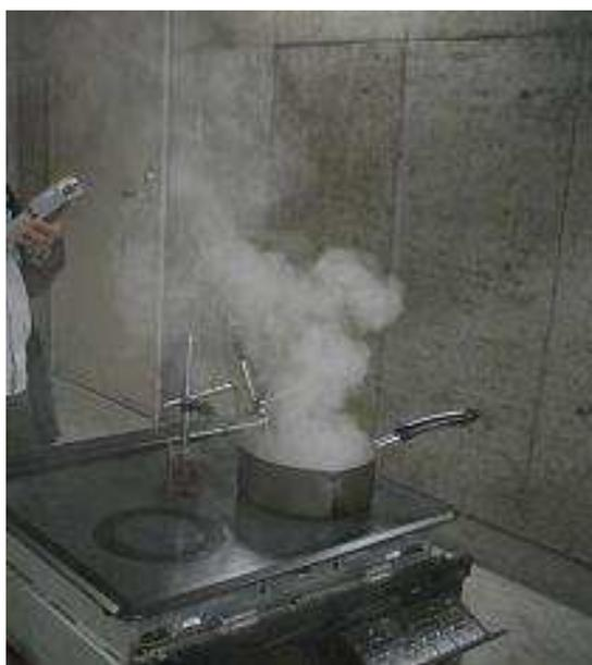
IHこんろ(電磁調理器)で付属の揚げ物専用鍋を使用せず、揚げ物モードで規定の油量より少量の油を入れて行った火災実験の写真です。
