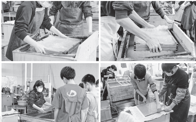
②ほどよく水分が抜けたら、金属製の乾燥機に貼り付けます。賞状等に用いられる厚さ「2枚漉き」には、30分ほどかかります。
