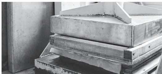
①漉いた紙には多くの水分が含まれているため、写真のように圧力を加え、一晩かけてゆっくりと水分を抜きます。
