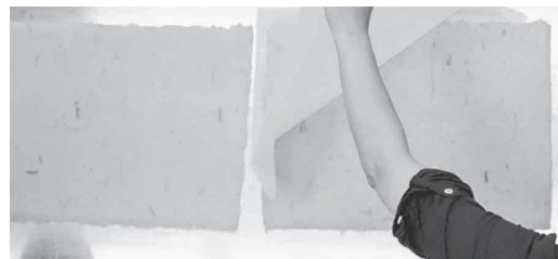
②ほどよく水分が抜けたら、金属製の乾燥機に貼り付けます。賞状等に用いられる厚さ「2枚漉き」には、30分ほどかかります。
