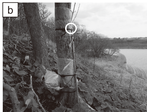
図2 インターバルカメラと温度計の設置状況。(a) 釧路市立博物館の非常階段。(b) 湖岸の木。
